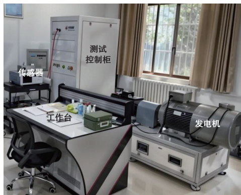
图 2 发电机控制场景示意图
