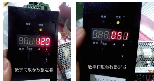
图 5 试验中电动缸实时工作电流监测
