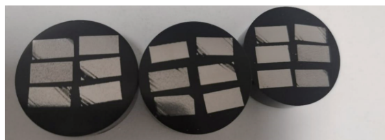
图 6 金相处理研磨所得到的 3%、5%、7% 3 组实验成品
