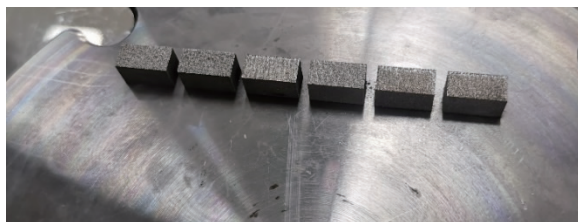
图 5 SLM 实验一次性打印的第一组配方成品
