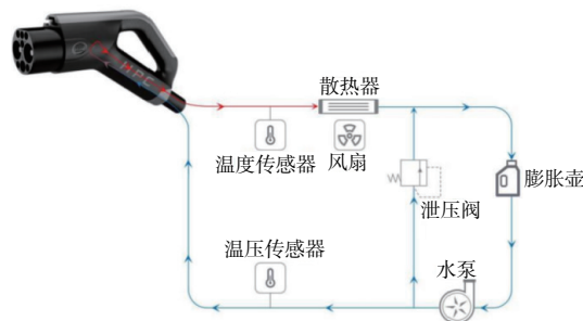
图 3 超充电桩冷却系统工作原理图
