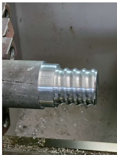
图 5 椭圆牙型加工结果
