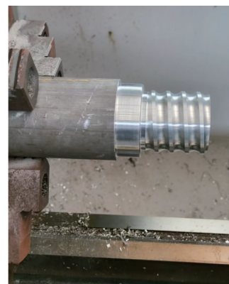
图 9 抛物线牙型加工结果
