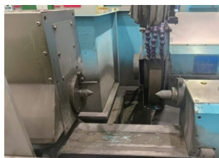
图6 划片刀外圆数控磨床
