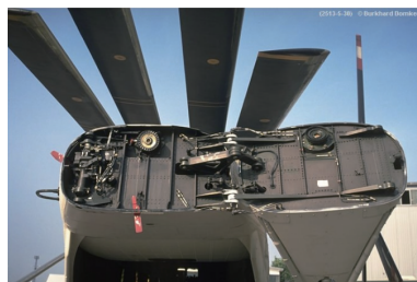
图 3 AS332 折叠型尾轴结构示意图
