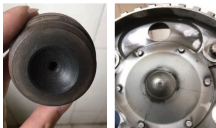
图8 支撑堵头及支撑帽磨损示意图
