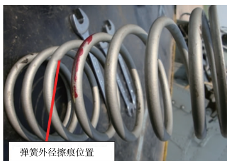
图6 弹簧擦痕照片
