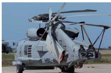
图 1 SH-60 黑鹰尾翼的折叠状态
